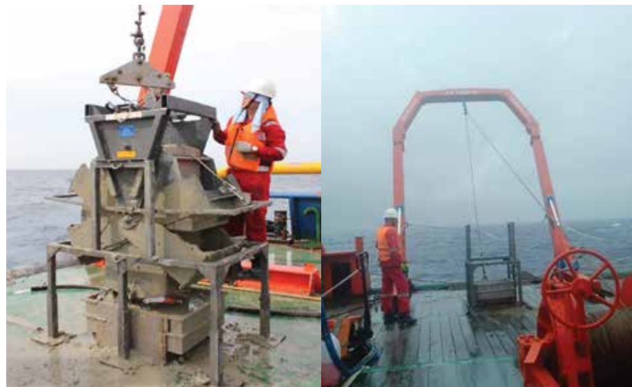
Hình 1. Thu mẫu trầm tích bằng gầu Boxcoer để sử dụng cho các thử nghiệm mô phỏng.
